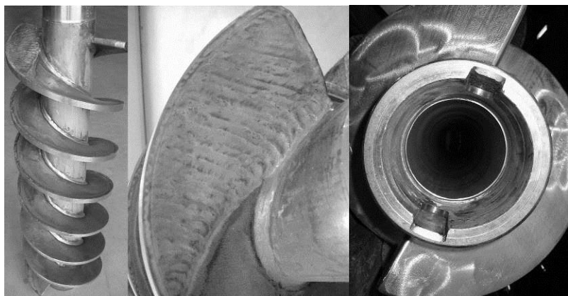
Рис.13-11: Шнек с твердосплавным специальным облицовочным покрытием и гнездом оси, новое состояние
