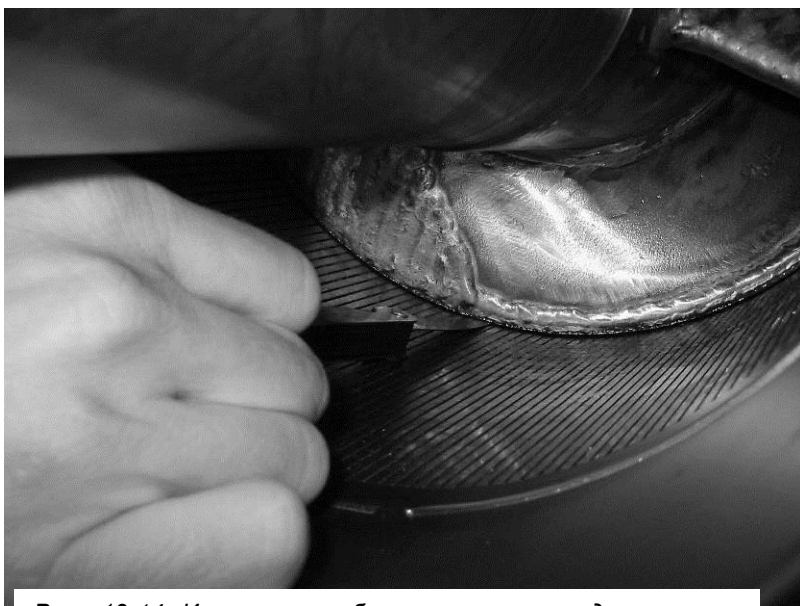
Рис. 13-14 Измерение рабочего зазора между ситом и шнеком, измеряется на нижней стороне сита при остановке машины, измерение показывает двукратный рабочий зазор, так как в состоянии покоя сито лежит
