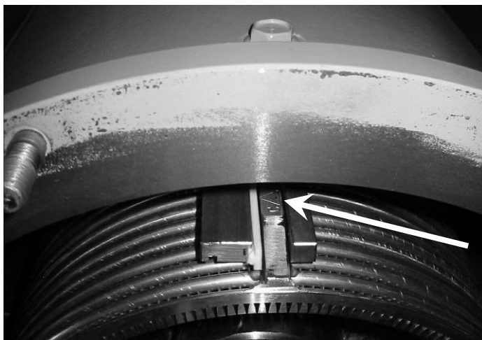
Рис. 13-9 Установочное положение сита, отштампованный треугольник сверху и вперед к сепаратору
